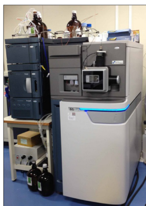
図4 オミックス解析基盤 ToMMoのオミックス解析に使われている質量分析機とNMR装置。
