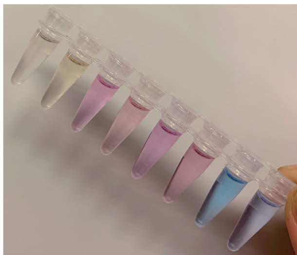
図6 一つの野生型光受容体分子を基に改変した光受容分子群。右端が野生型の分子で、それ以外の七つは改変分子。それぞれが異なる光質を感知している。
